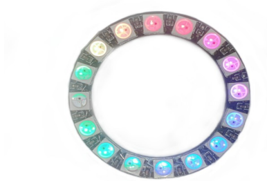
Bild 5: LED-Ring mit IC Chips
